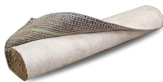
VOLGRIP EP este o geomembrană din bentonită, compusă din bentonită de sodiu încapsulată între două geotextile, pentru impermeabilizarea eficientă a structurilor de reținere a apei sau a structurilor de depozitare și eliminare a deșeurilor, fie că sunt construite cu sol natural sau cu beton.
